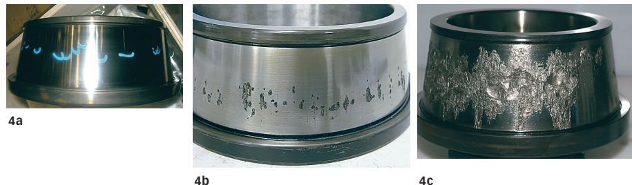
图4: 失效外观: a)直线裂纹, b)直线裂纹和小剥落, c)剥落。
