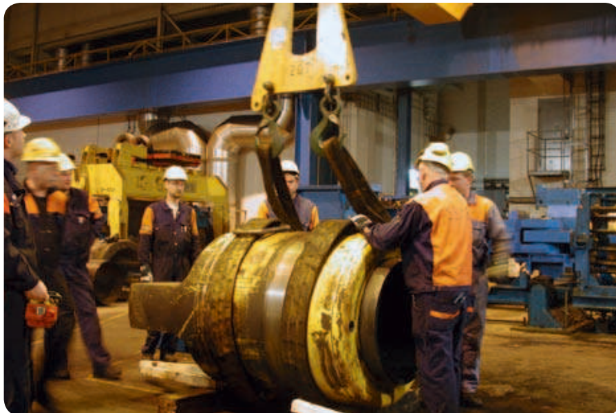
高扭矩要求对热轧机安装和拆卸步骤带来了挑战。
